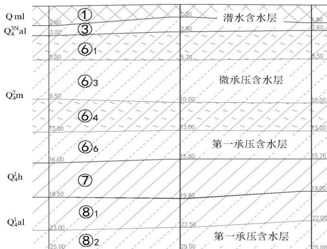
图 2 滨海软土地层地下水分层示意图
