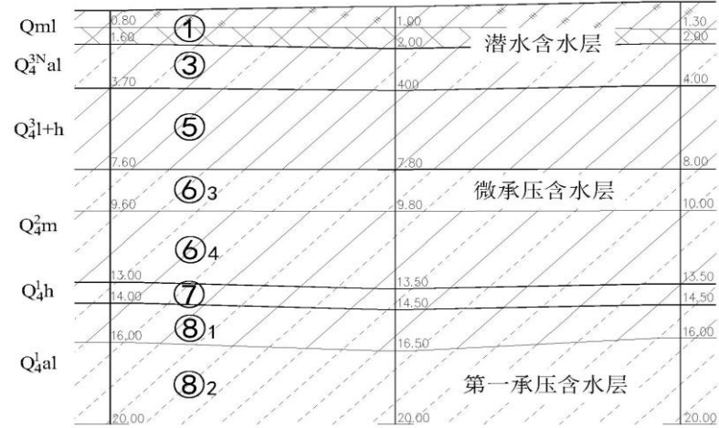
图 1 中心城区西北地区地下水分层示意图
