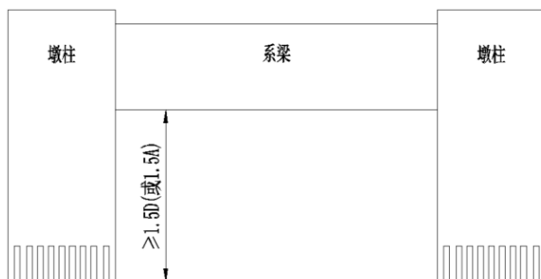
图 7.0.16-2 顶部系梁预制示意图
